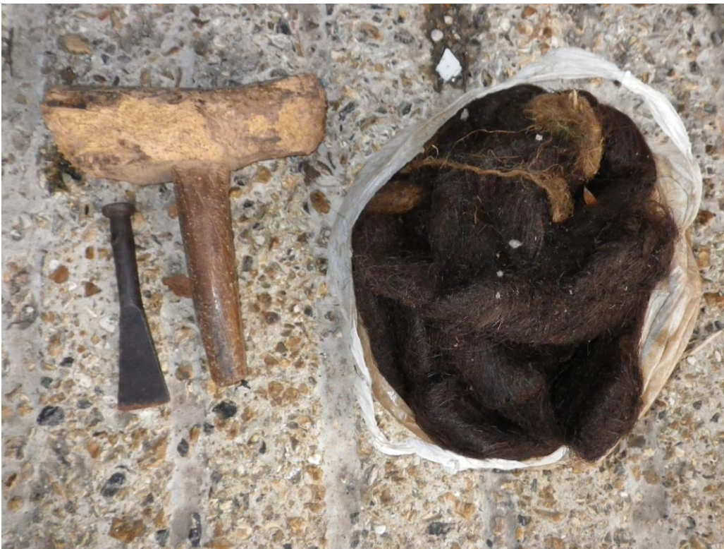
Sac d'étaupe, burin à calfater et maillet en chêne d'une seule pièce de plus de 100 ans
